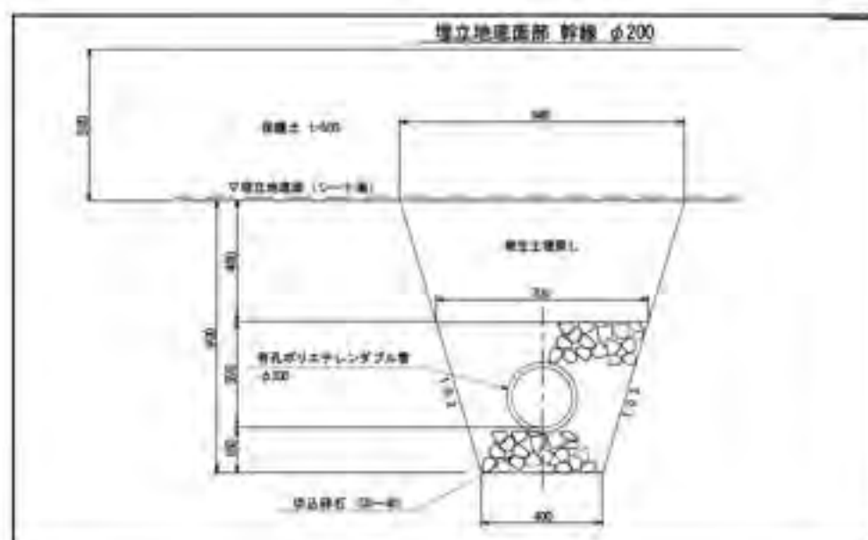
図 2.2-6 地下水集排水施設構造図(一例)
