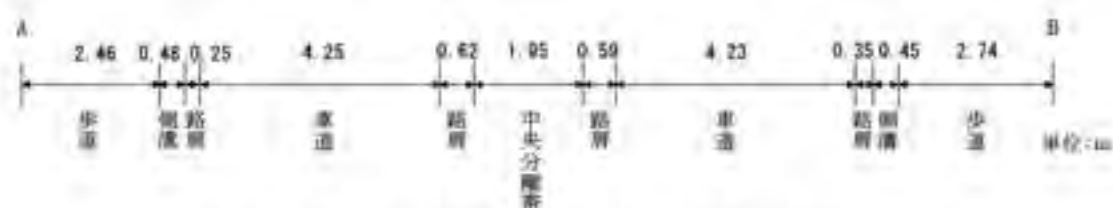
図 6.1-12 町道の道路構造 (St. 2 : 北側沿道地点)
